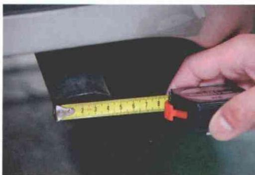
排気管出口口径の測定
