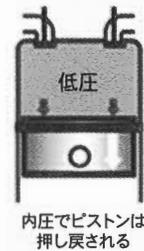
図-30 従来の排気ブレーキにおける膨張行程
