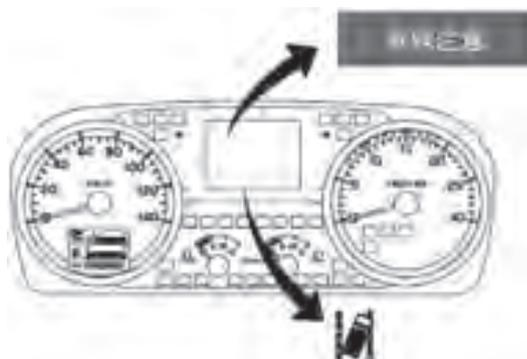
システム作動中に車線を越えると、警報音「ビッビッ」を発生し、マルチ・インフォメーション・メイン表示部に「車線注意」を表示すると共に、マルチ・インフォメーション・インジケータ表示部内の車線逸脱警報ウォーニング・ランプが点灯する。
