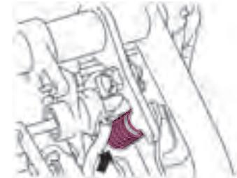
図-81 ブレーキ・ペダルの取り付け④
