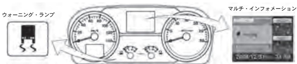
VSC作動時、マルチ・インフォメーション「VSC作動」を表示及びウォーニング・ランプを点灯し、同時にブザーを断続して吹鳴させ警報を発する。
