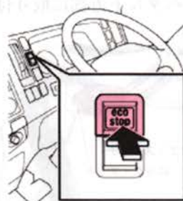
図 I-6 ecostop キャンセル・スイッチ取り付け位置
