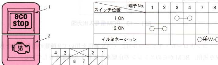
図 I-12 ecostop キャンセル・スイッチ端子
