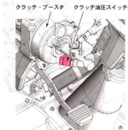
図I-8 クラッチ油圧スイッチ取り付け位置
